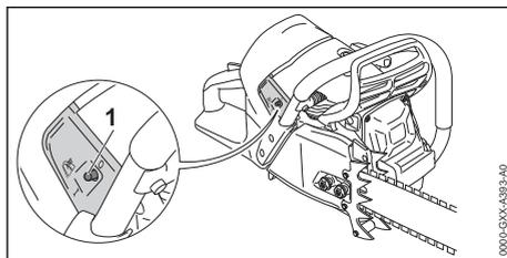
**1 Interrupteur de chauffage de poignées**
